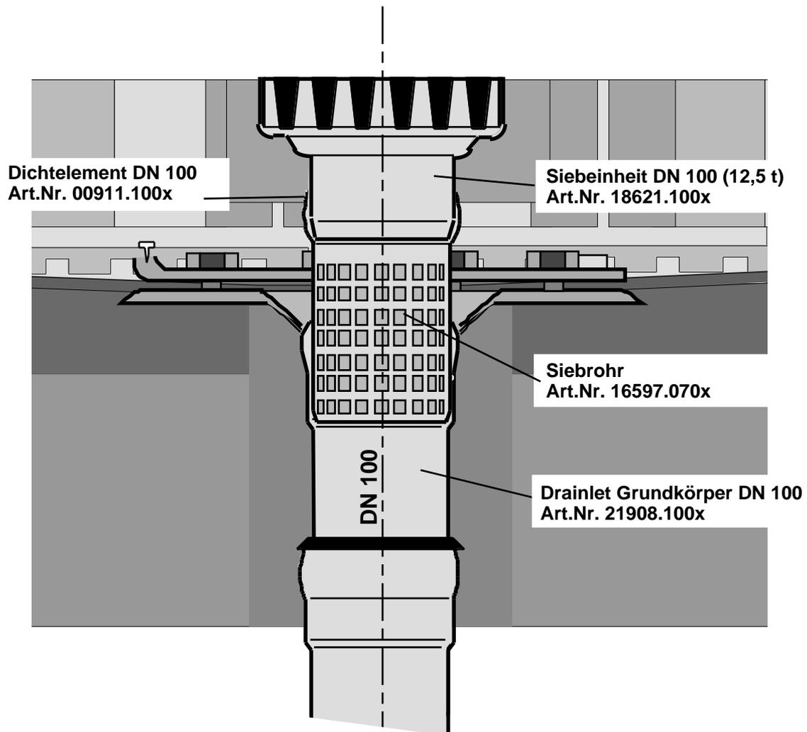
Die Siebaufnahme ist in eine Lastverteilungsschicht einzu-
